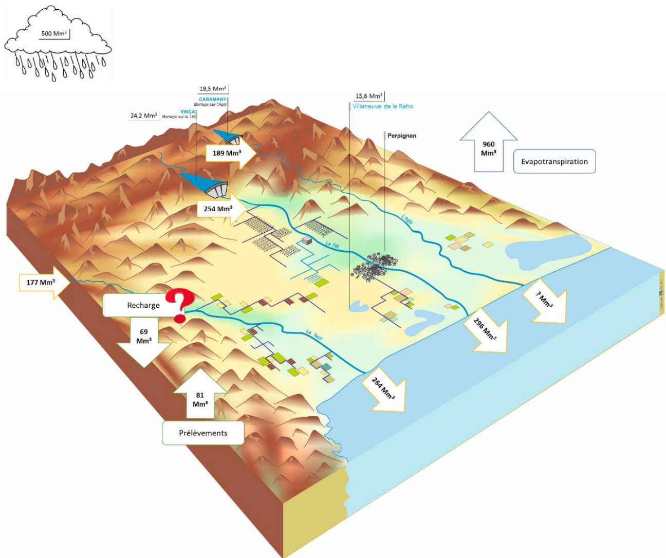
Figure 1 : Schéma bilan des flux annuels connus et non connus sur la plaine du Roussillon (données : études volumes prélevables nappe du Roussillon, banque HYDRO et VULCAIN ; schéma BRLi)
